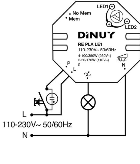
Ejemplo de sustitución de una instalación conmutada por una instalación con regulador y pulsadores:
