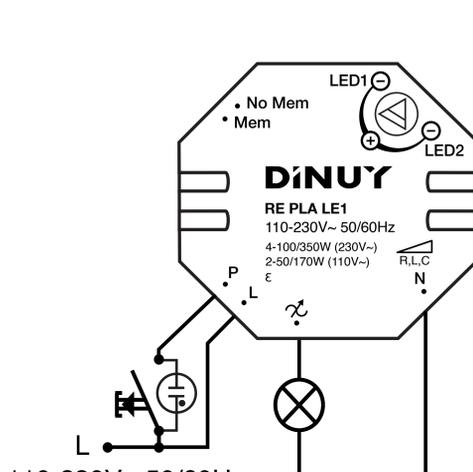
Exemple de remplacement d'une Installation (commutée) conventionnelle par une installation avec variateur et bouton-poussoir.
