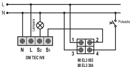
· Detector de movimiento + Pulsador Temporizado "PT EMP EL4" o "PT GAR EL1": la lámpara se encenderá si Pulsador Temporizado y no se detecta movimiento.
