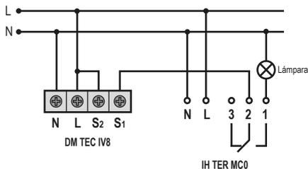
· Detector de movimiento + Minutero "MI PLA 002": la lámpara se encenderá si se acciona el Minutero, a través del pulsador, y no se detecta movimiento.
