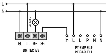
· Detector de movimiento + Minutero "MI EL3 003" o "MI EL3 304" + Contacto de puerta inalámbrico ("SE KNX 003" + "TM KNX 001"): la lámpara se encenderá si se acciona el Minutero, a través del pulsador, no se detecta movimiento y la puerta está cerrada.
