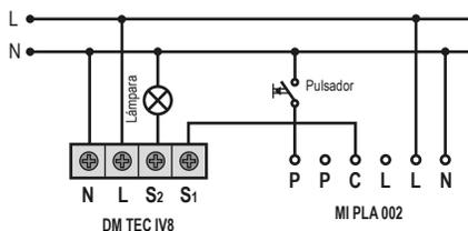
· Detector de movimiento + Minutero "MI EL3 003" o "MI EL3 304": la lámpara se encenderá si se acciona el Minutero, a través del pulsador, y no se detecta movimiento.
