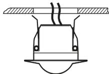
Realice el cableado según el Punto 5 e introduzca el sensor en el orificio realizado previamente y a continuación ajuste el valor tiempo, según el Punto 6.
